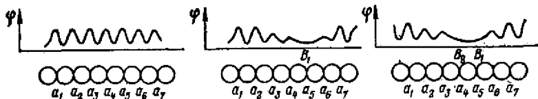
Рис. 106. Распределение адсорбционного потенциала \varphi на поверхностных атомах твердого тела.
