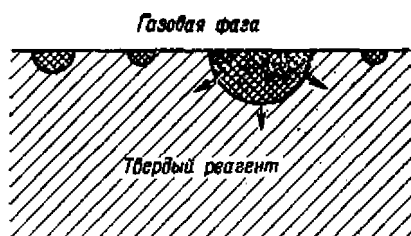
Рис. 63. Вид сечения твердого реагента с растущими сферическими ядрами твердого продукта.
